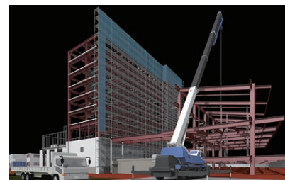
BIM施工計画の例
