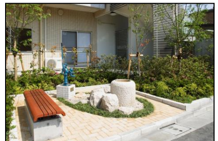
建物の敷地内に井戸とかまどになるベンチを設置。災害時、防災の拠点となる建物を目指しています。
