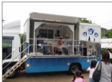
免震と耐震の2つの揺れで過去の地震を再現し、体験ができる日本初の起震車。
