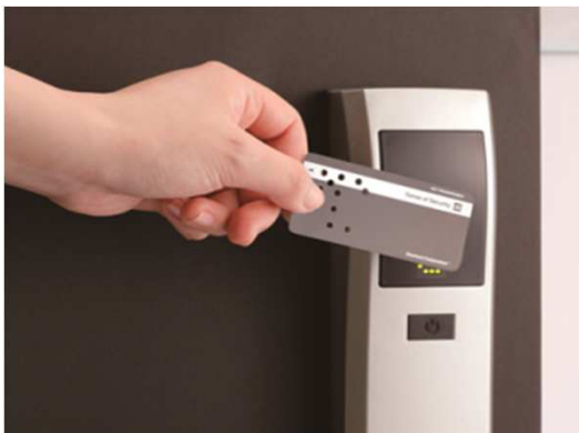
シャロック(カードキーシステム)
